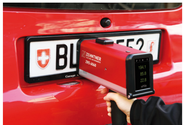
Measurement of retroreflective number plates / Medição de Chapas de matrícula retrorrefletores
