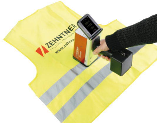
Versions with observation angle \alpha 0.2^\circ are suitable for measuring safety garments / As versões com ângulo de observação \alpha 0.2^\circ são adequadas à medição de vestuário de segurança
