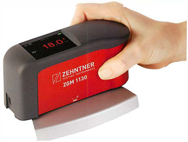
カーブした部分の測定も可能
