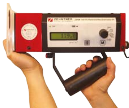
Kalibrierung mit Referenzstandard calibration with reference standard
