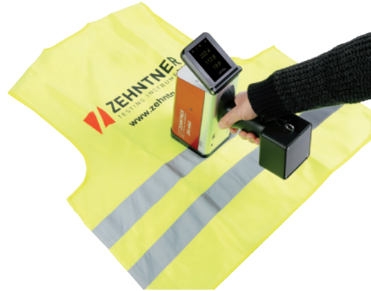
Mesurer des vêtements à haute visibilité avec angle d`observation \alpha 0.2° / Ausführungen mit Beobachtungswinkel \alpha 0.2° sind geeignet zur Messung von Warnkleidung
