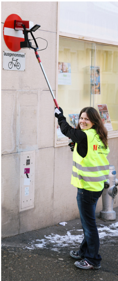
Poignées optionelles pour mesurer des panneaux de signalisation de haute altitude / Optionale Haltegriffe für hoch positionierte Verkehrszeichen
