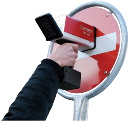
Zustandskontrolle von Verkehrszeichen für sichere Strassen / Monitoring traffic signs on site to increase road safety
